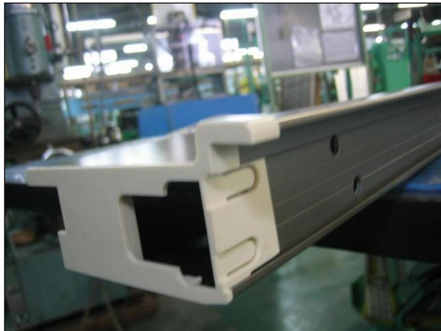
推開窗內扇、門扇直料上下端包覆有安全套蓋，可防止打掃或正常使用情況下不經意的受傷情況發生。(標準配備)
